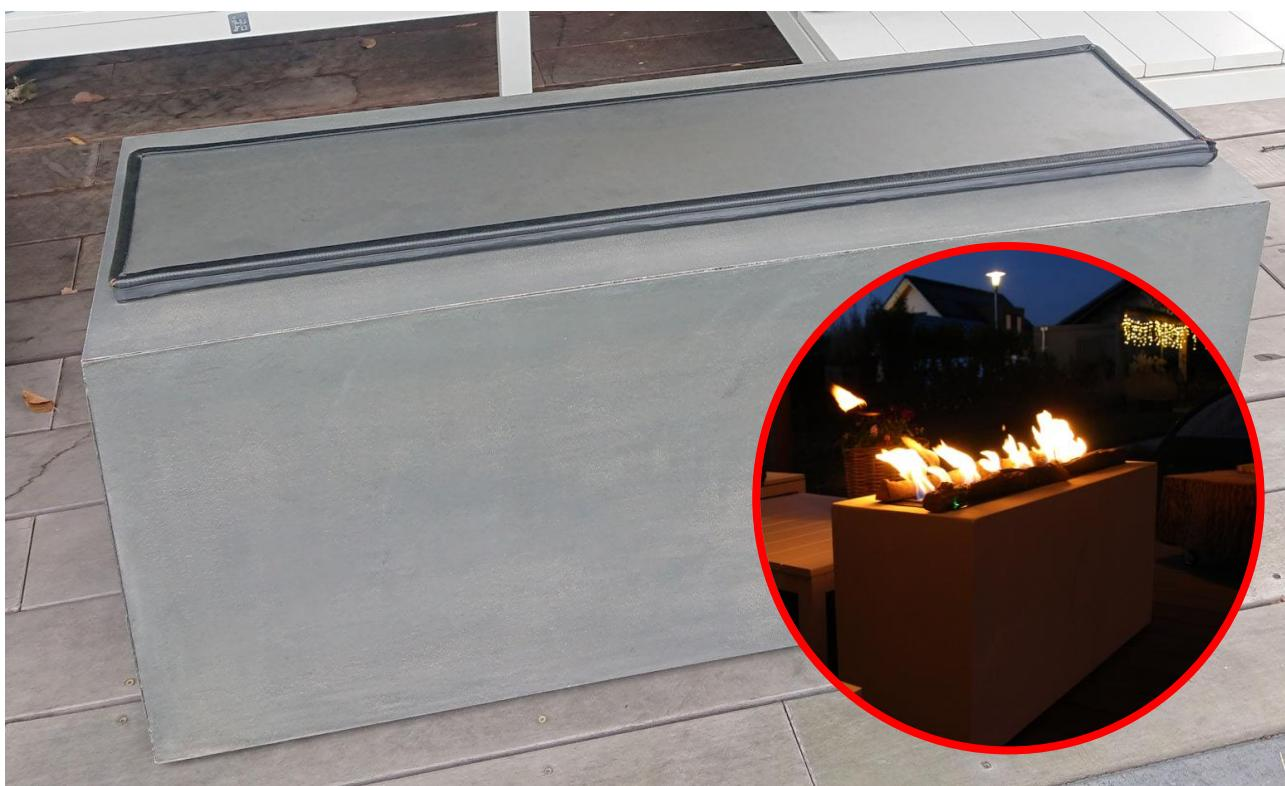
In bovenstaand voorbeeld is een RVS plaat van 3 mm dikte gebruikt (+/- 105 x 23 cm). Die is zwaar genoeg om niet weg te waaien bij harde wind. Belangrijk hierbij is dat de plaat over de gehele brander valt (de brander is 100 x 19,3cm), zodat de rubber afdichting de gehele brander afschermt.
