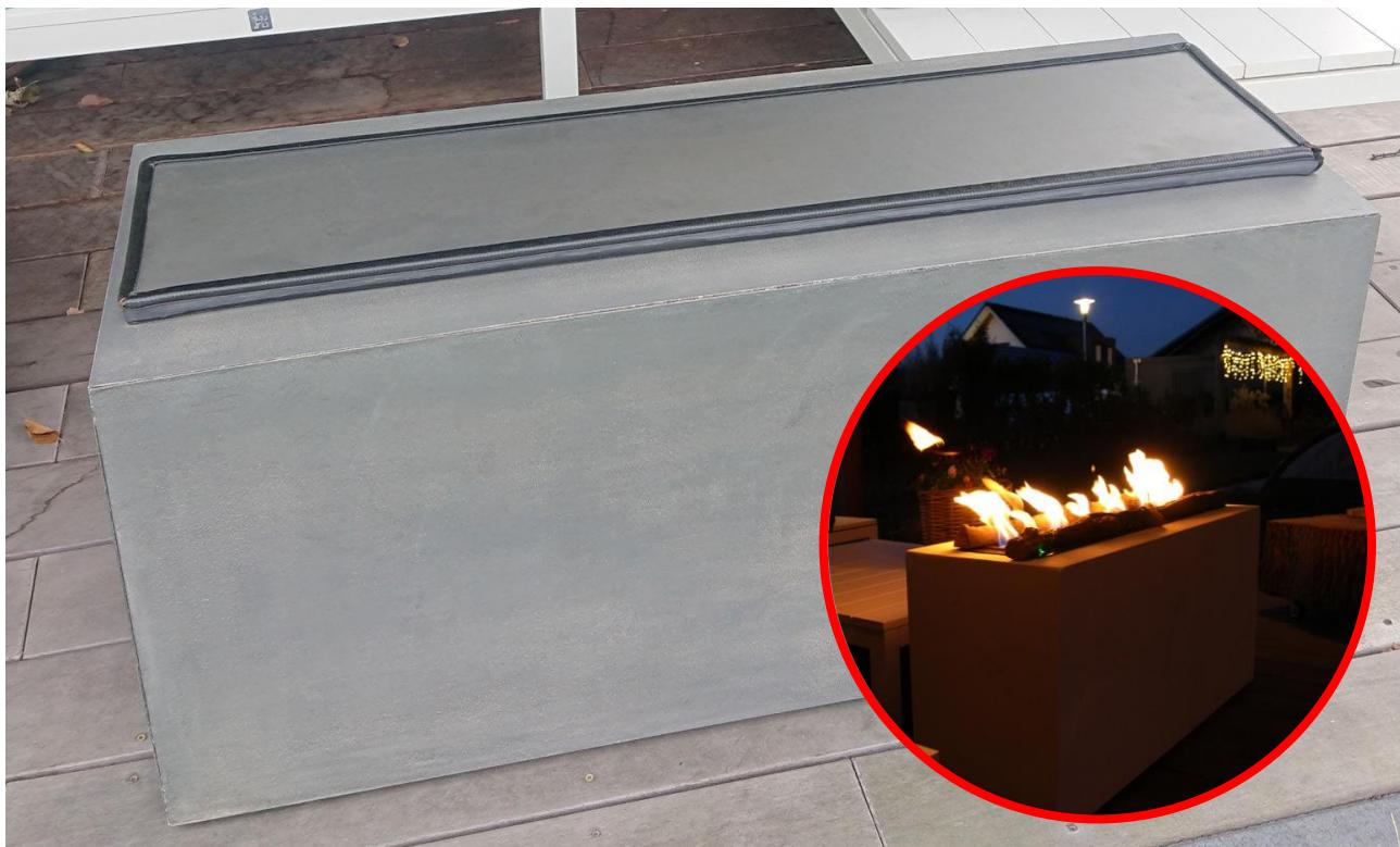
En el ejemplo anterior, se utilizó una placa de acero inoxidable de 3 mm de espesor (+/- 105 x 23 cm). Es lo suficientemente pesado como para no volar con vientos fuertes. Es importante que la placa cubra todo el quemador (el quemador mide 100 x 19,3 cm), para que la junta de goma proteja todo el quemador.
