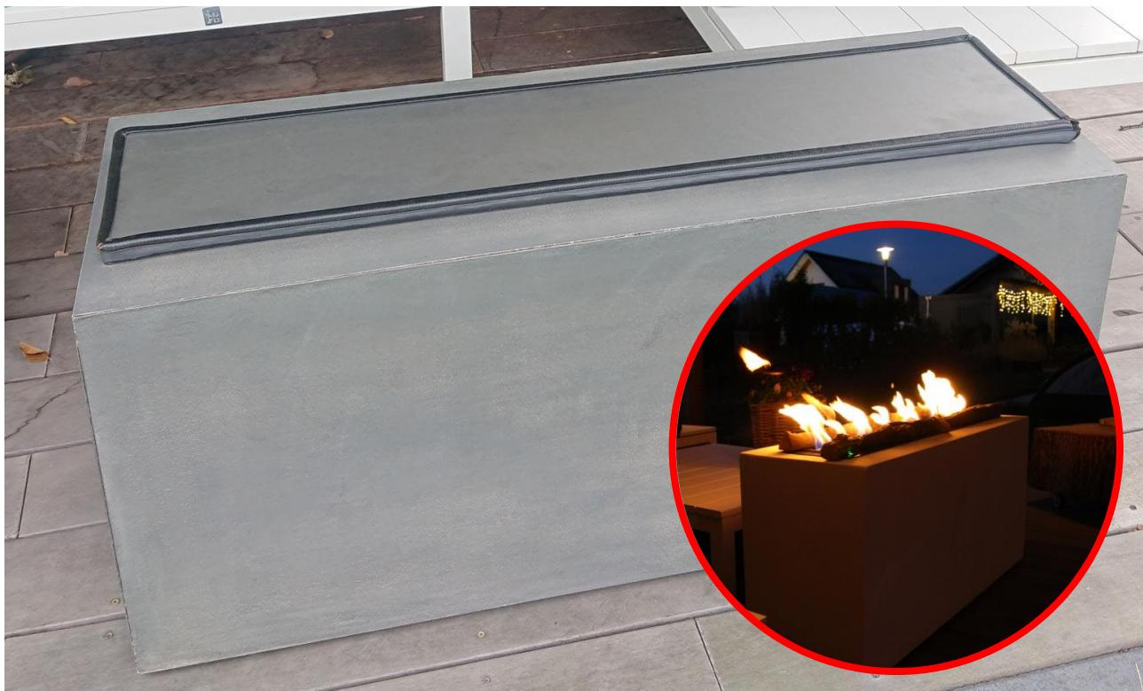
Dans l'exemple ci-dessus, une plaque d'acier inoxydable de 3 mm d'épaisseur a été utilisée (+/- 105 x 23 cm). Il est suffisamment lourd pour ne pas être emporté par des vents forts. Il est important que la plaque recouvre tout le brûleur (le brûleur mesure 100 x 19,3 cm), de sorte que le joint en caoutchouc protège l'ensemble du brûleur.
