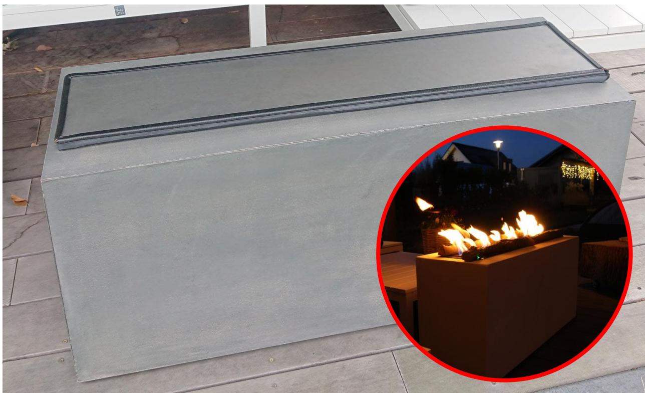
W powyższym przykładzie zastosowano płytę ze stali nierdzewnej o grubości 3 mm (+/- 105 x 23 cm). Jest wystarczająco ciężki, aby nie wiać przy silnym wietrze. Ważne jest, aby płyta zakrywała cały palnik (palnik ma wymiary 100 x 19,3 cm), tak aby gumowa uszczelka chroniła cały palnik.
