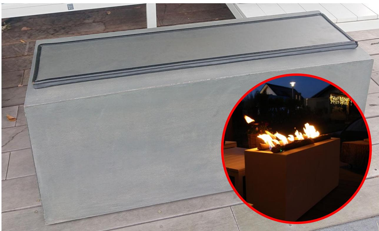
Nell'esempio sopra, è stata utilizzata una piastra in acciaio inossidabile di 3 mm di spessore (+/- 105 x 23 cm). È abbastanza pesante da non soffiare via con vento forte. È importante qui che la piastra copra l'intero bruciatore (il bruciatore è 100 x 19,3 cm), in modo che la guarnizione in gomma protegga l'intero bruciatore.
