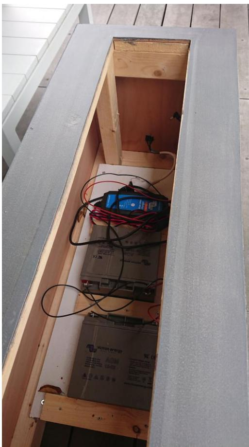
La ricarica può essere eseguita con un caricabatterie, ad esempio il caricabatterie [Victron Blue Smart](#). Il vantaggio di questo caricabatterie è che può essere letto tramite una connessione Bluetooth con il telefono, utile se le batterie e il caricabatterie sono nascosti in un luogo dove non è facile da raggiungere. Nella foto a sinistra si vedono entrambe le batterie + caricabatteria nascosti nella scatola mobile.
